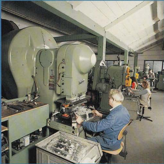
Für die Metall-Verformung stehen Pressen bis 500 t Druckleistung zur Verfügung.
